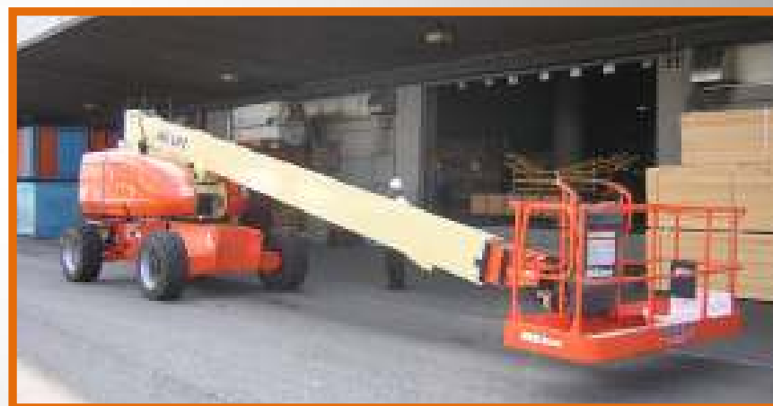
800S(ストレートブーム) 最大作業床高さ:24.38m 機械重量:約 15トン 積載荷重:230kg
